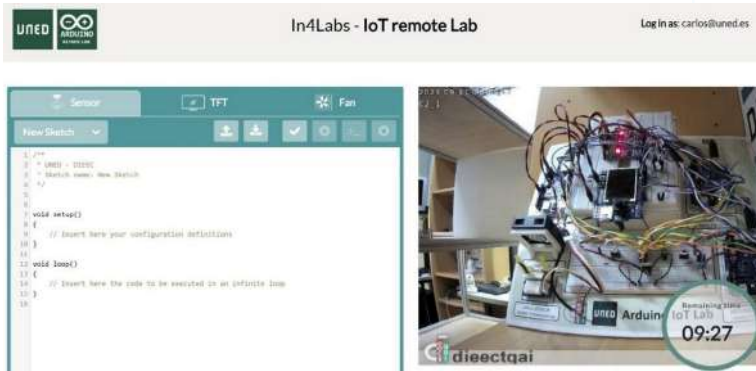
Figura 1. Interfaz del laboratorio remoto IoT (panel del código y cámara web).
